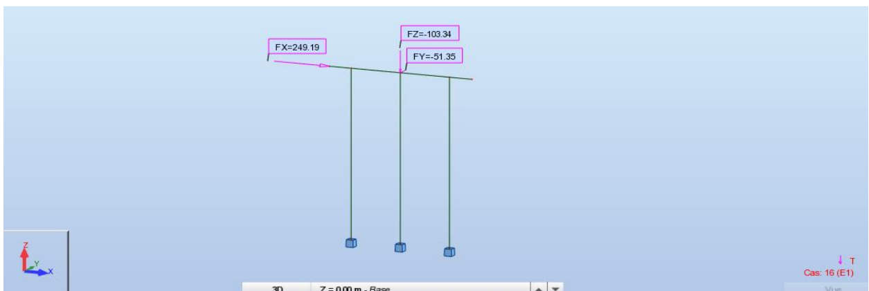
Figure I-12 : Vue sur le chargement sous E1
