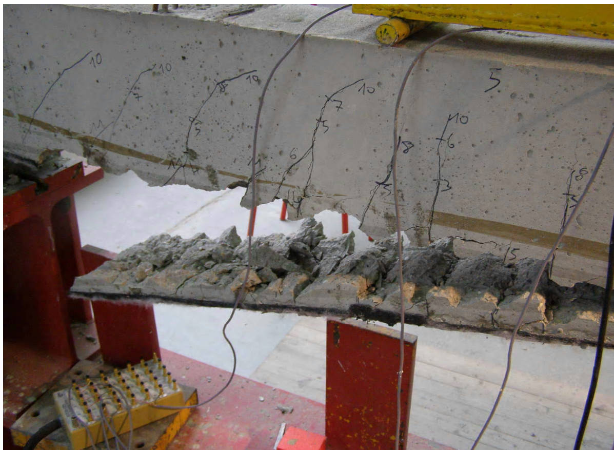
Figure 1.5.4 Décollement de la plaque TRC (aramide + joncs carbone)
