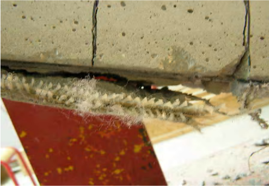
Figure 1.5.2.décollement de la plaque de TRC (aramide 3 couches).
