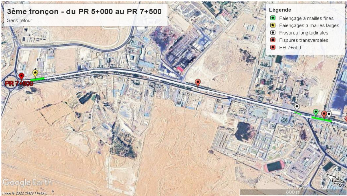
Figure IV.7 Exemple de localisation des dégradations entre le PR05+000 et PR 07+500 –sens retour-.
