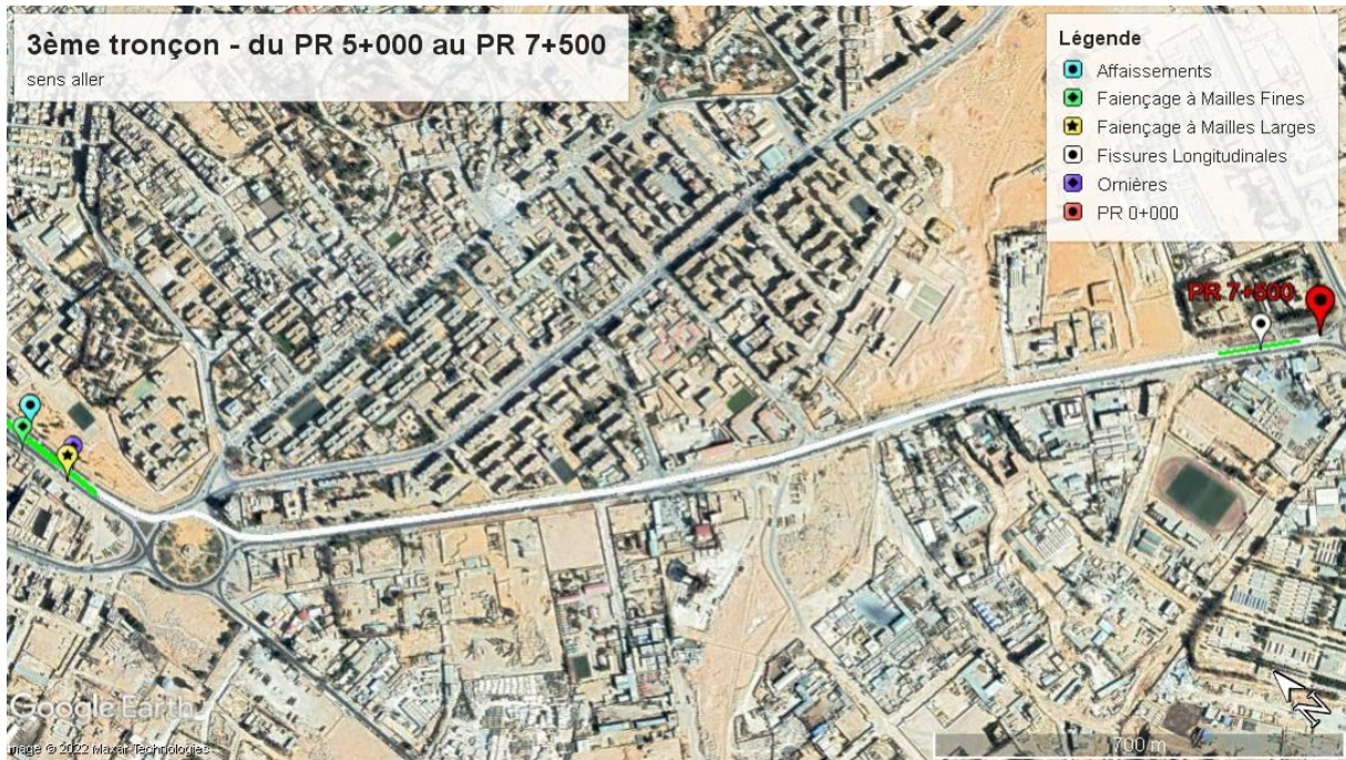
Figure IV.4 Exemple de localisation des dégradations du PR05+000 au PR 07+500 –sens aller-.
