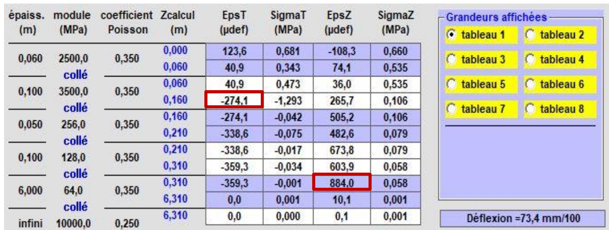
Figure VI.13 Modélisation des déformations de la chaussée de la ZH01 –sens retour- dans la phase 1 du projet par ALIZE.
