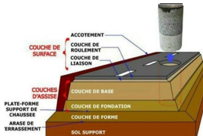
Figure III.1 Structure de chaussée.
