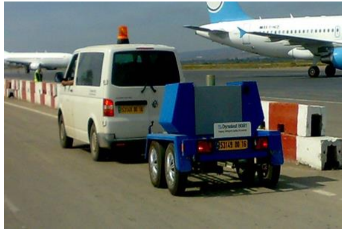
Figure IV.19 Défectomètre à masse tombante (HWD).
