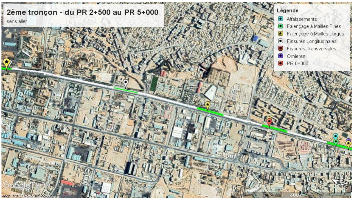
Figure IV.3 Exemple de localisation des dégradations du PR02+500 au PR 05+000 –sens aller-.
