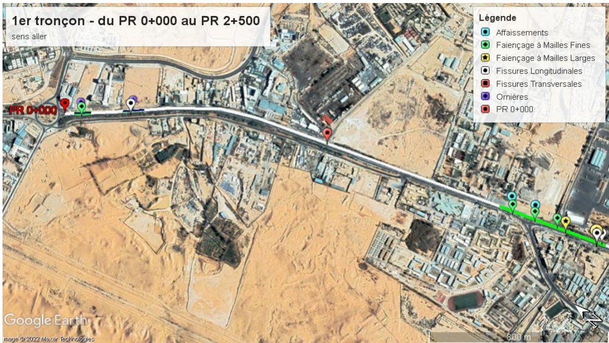
Figure IV.2 Exemple de localisation des dégradations du PR0+000 au PR 02+500 –sens aller-.
