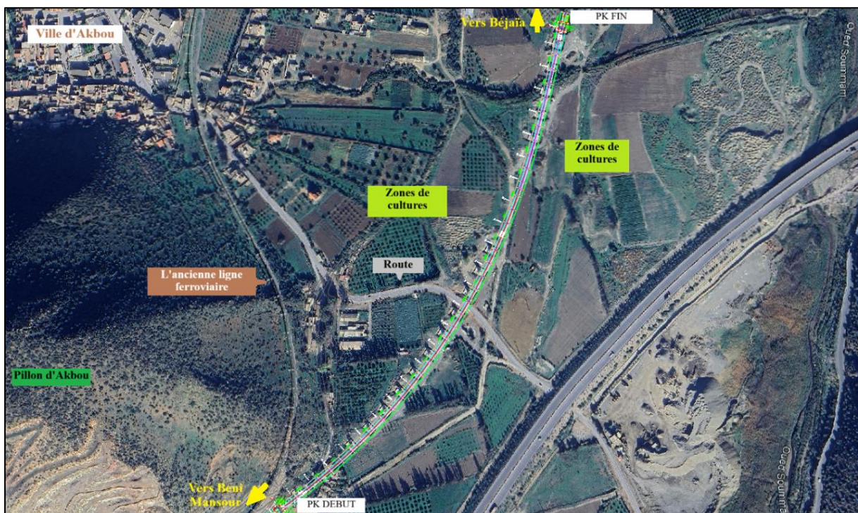
Figure I.3. le tracé en plan du projet en indiquant les contraintes de site
