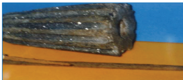
Figure.I.5. Cône Freyssinet en mortier au carborundum. (2)
