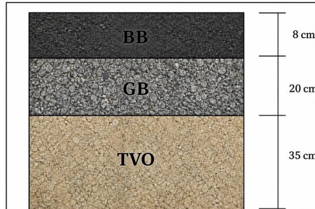
Figure IV . 1 : Structure retenue par la méthode CBR
