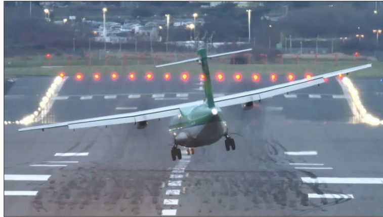
FIGURE II.2. CAS D'ATERRISSAGE D'UN AVION AVEC UN FORT VENT TRAVERSIER
