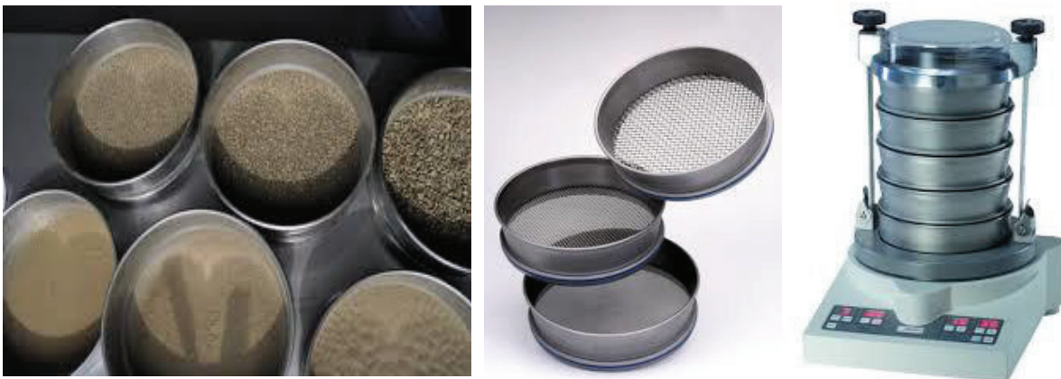
FIGURE V.6. MATERIELS UTILISES DANS L'ANALYSE GRANULOMETRIQUE PAR TAMISAGE
