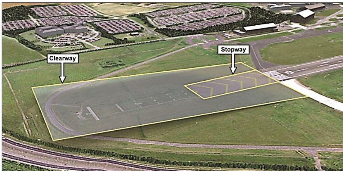
FIGURE IV.4. PROLONGEMENT D'ARRET (STOPWAY) ET PROLONGEMENT DEGAGE (CLEARWAY)
