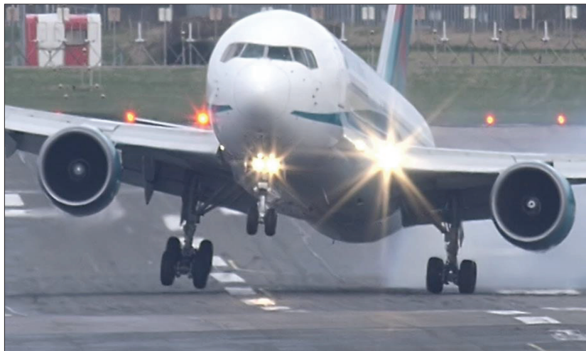
FIGURE VII.1. L'INTERACTION ATERRISSEUR-PISTE EN PHASE D'ATERRISSAGE
