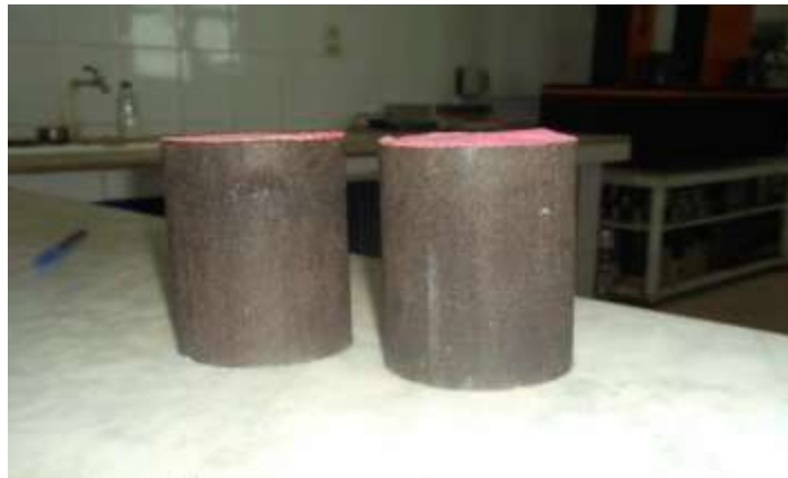
Photo (IV.7) : Exemple des éprouvettes confectionnées de l'essai Duriez
