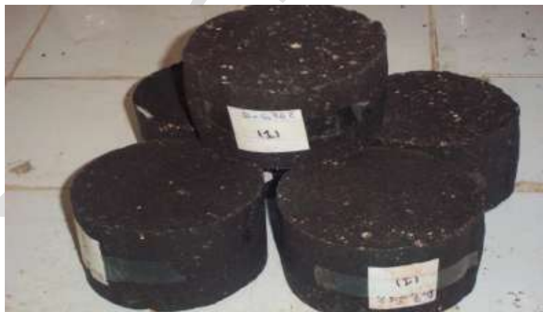
Photo (IV.3) : Exemple des éprouvettes confectionnées de l'essai Marshall
