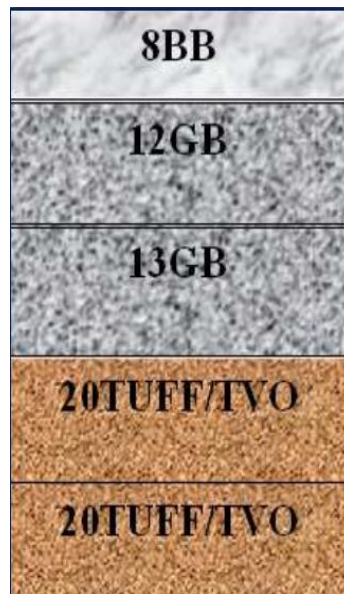
Figure VI.5 : La structure de chaussée adoptée
