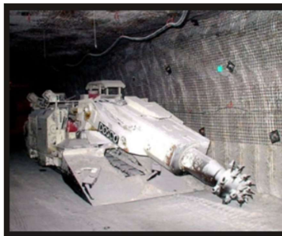
Figure VI-9 machine a attaque ponctuel
