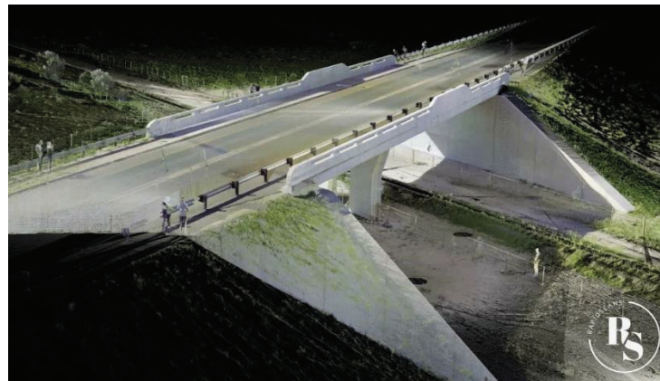
Figure I. 5 : Scanner laser 3D d'un pont.
