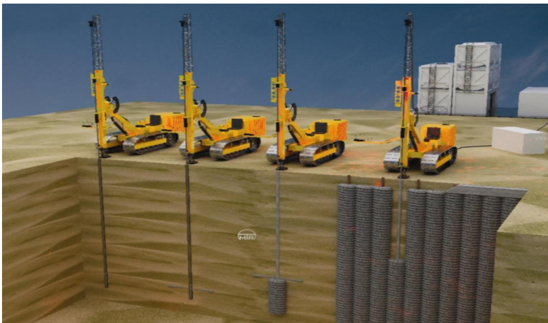
FigureII.10 : procédure du jet-grouting. [8]
