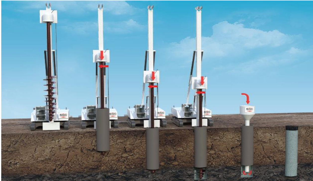
Figure II.11 : Procédé de pieux forés par tubage
