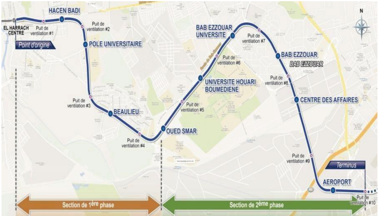
Figure I.3 : Tracé de l’extension EL HARRACH - AÉROPORT D'ALGER
