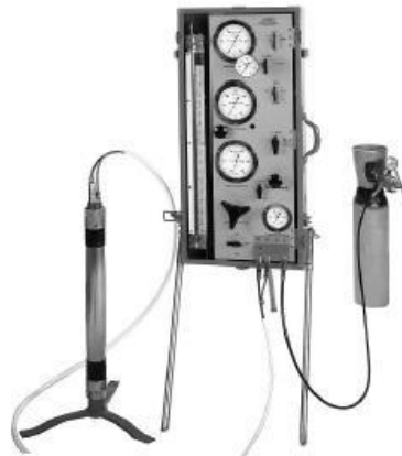
Figure III.3 : : Ensemble pressiométrique Menard
