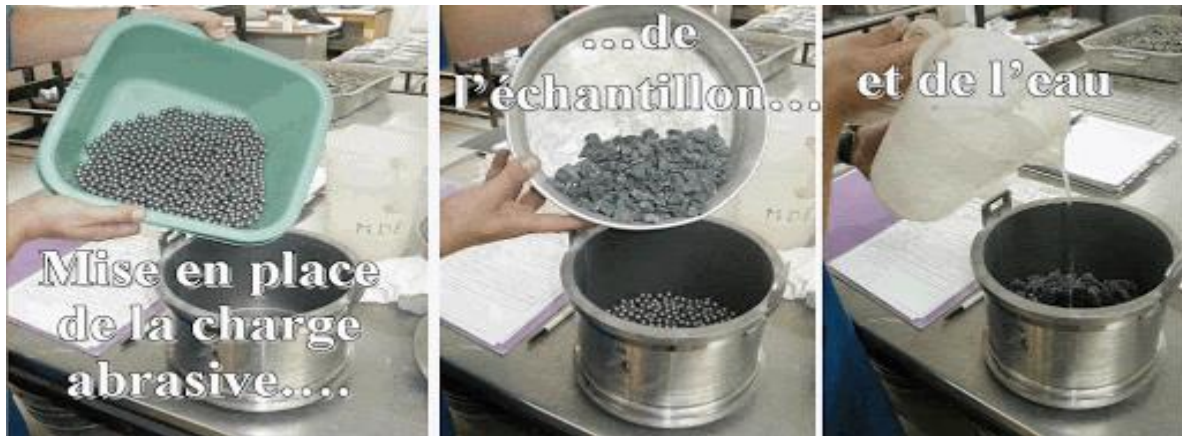
fig VI.9 : Essai Micro Deval
