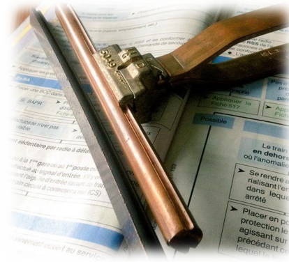
Figure XII.3 Fil de contact 107mm 2 rainures pour caténaire 1x25Kv.
