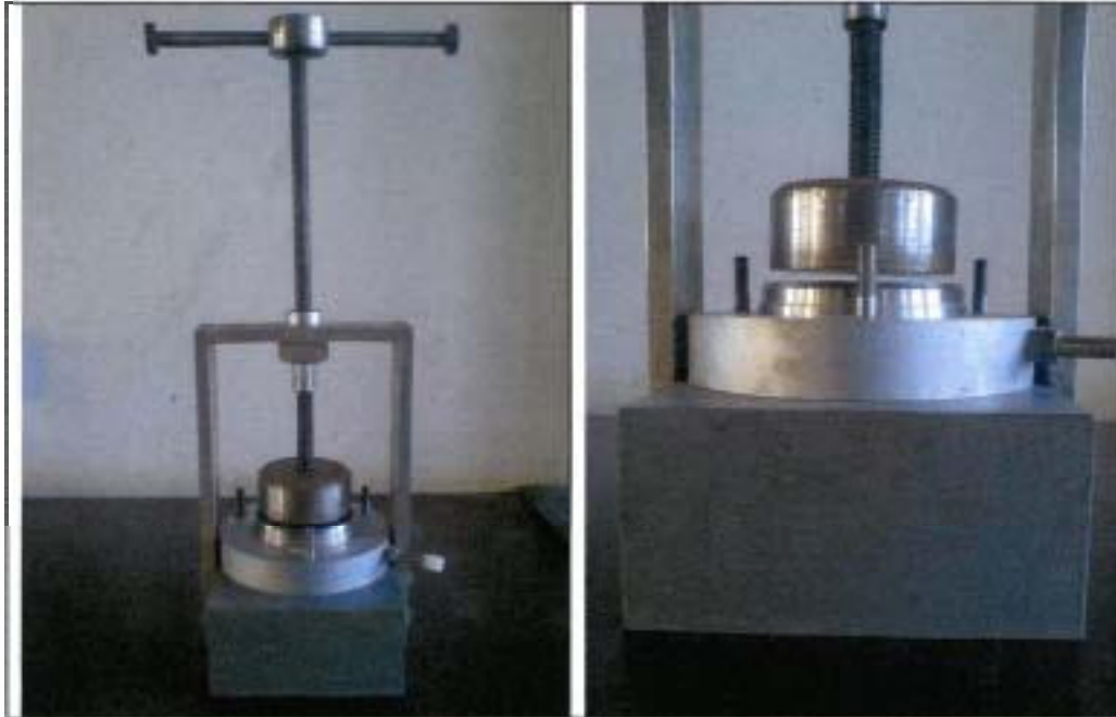
figure VIII.7. Compacteur statique pour la confection des éprouvettes de sol (réalisé au Laboratoire de l'Ecole) (Ramdane, 2007)
