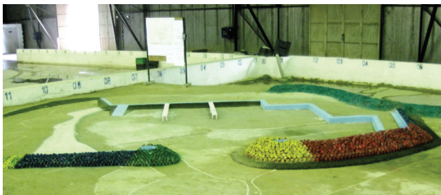
Photo V.1. Modèle réduit physique du port de pêche de Madagh réalisé par le LEM
