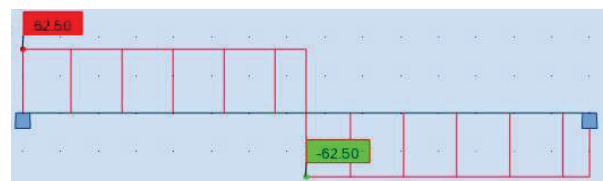
Figure F.26. Diagramme des efforts tranchant du couronnement du quai à -3.90m sous l'influence de Q (3ème cas)
