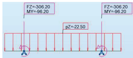
Figure H.23. Schéma statique de la semelle
