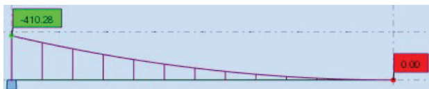
Figure D.35. Moment fléchissant à l'ELS du mur de couronnement en profil courant et musoir (jetée secondaire)
