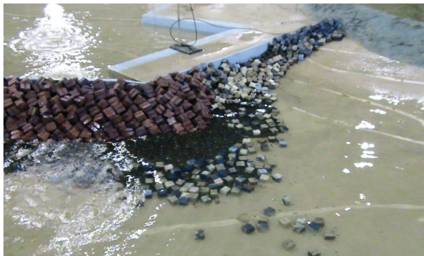
Photo E.3. Disparition presque totale des BCR au niveau de l'enracinement ainsi que le tapis en TVC après les essais
