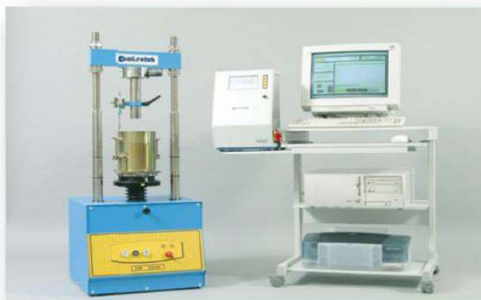
Figure .VIII. 4. Presse CBR avec système d'acquisition électronique.
