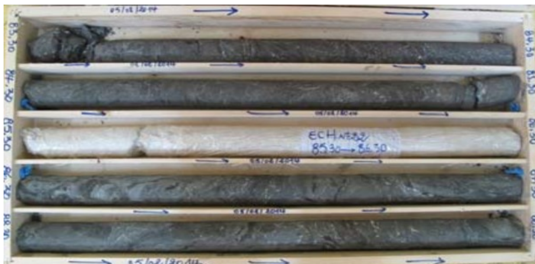
Figure IV. 9:Échantillon de V-1 pour calcul de RQD.
