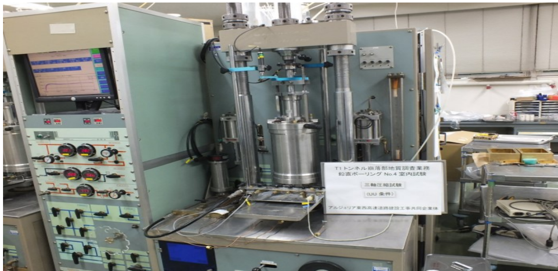
Figure IV. 7: Conditions de réalisation de l'essai tria-axial.
