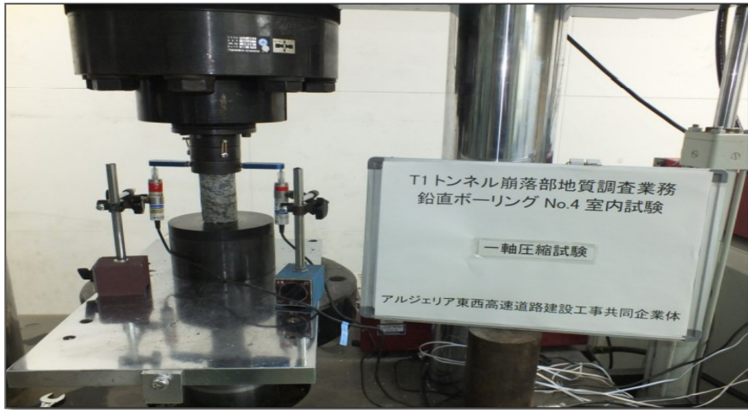
Figure IV. 5: Condition de réalisation de l'essai uni-axial
