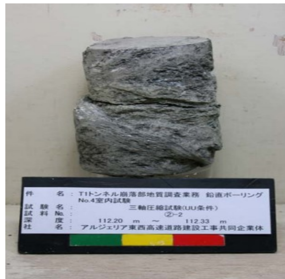
Figure IV. 8:Éprouvettes des échantillons avant et après l'essai (réalisé par Cojaal).
