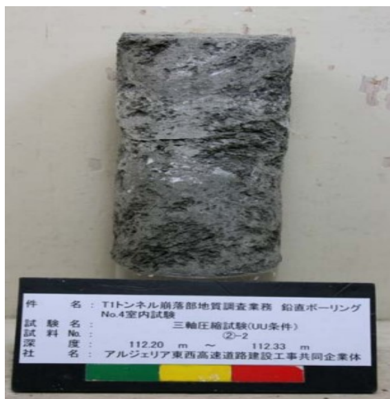
Figure IV. 8:Éprouvettes des échantillons avant et après l'essai (réalisé par Cojaal).
