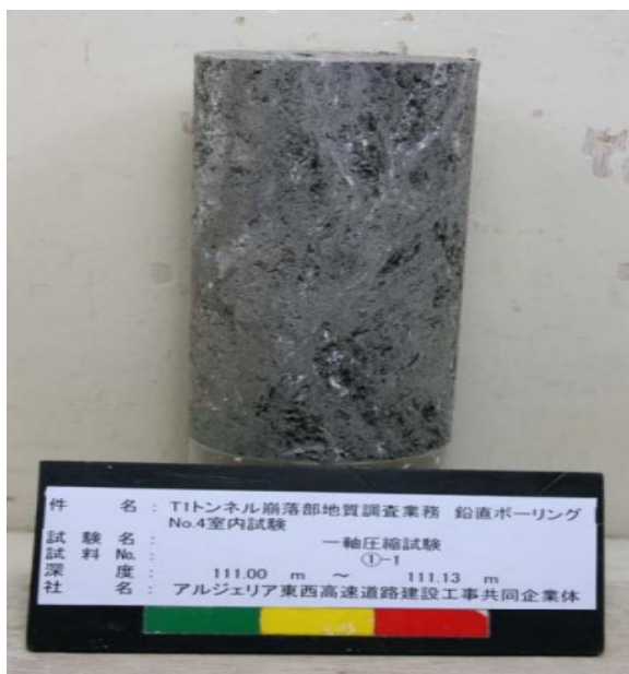
Figure IV. 6: éprouvette des échantillons avant et après la compression
