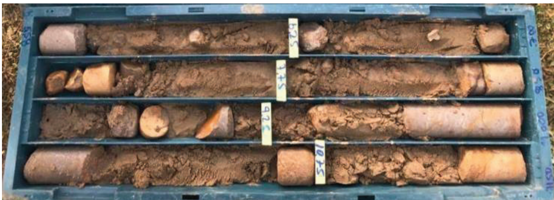
Figure A-3: Investigations géotechniques au PK 51+320 – Caisse 02: 5.5 à 11.5m
