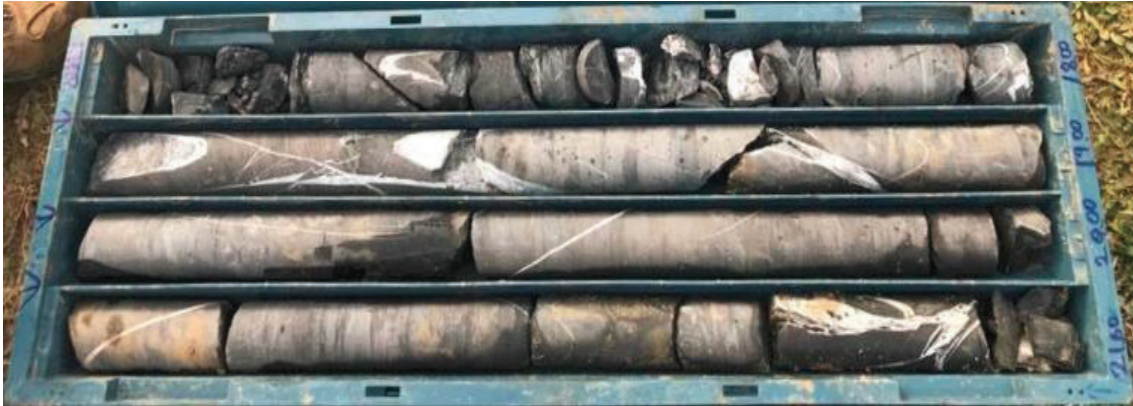
Figure A-5: Investigations géotechniques au PK 51+320 – Caisse 04: 17 à 21m
