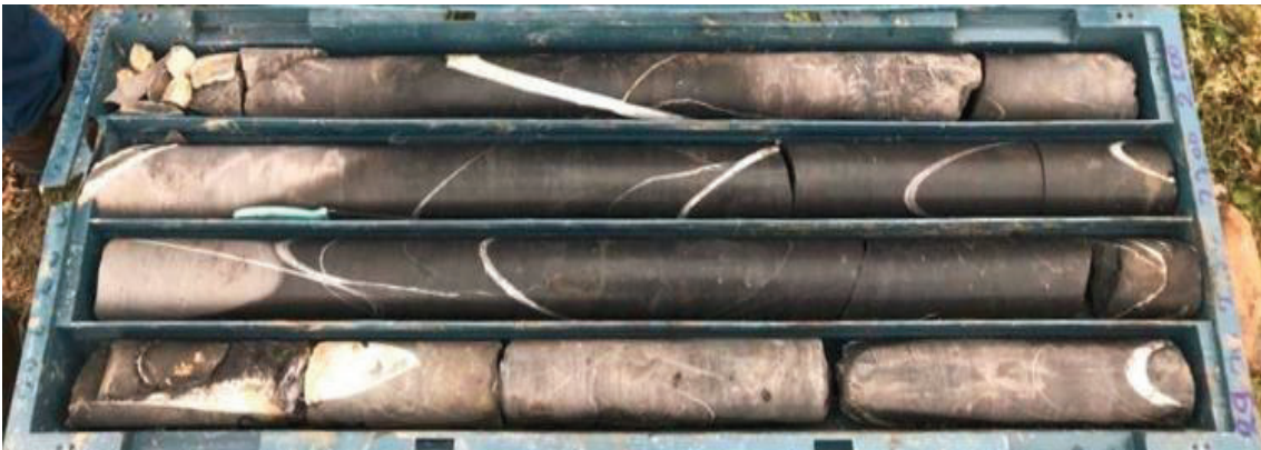
Figure A-7: Investigations géotechniques au PK 51+320 – Caisse 06: 25 à 29 m
