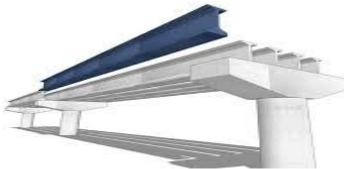
Figure I-3: Pont à poutres
