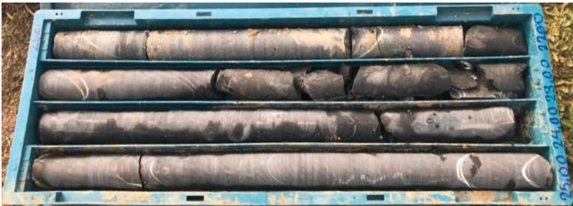
Figure A-6: Investigations géotechniques au PK 51+320 – Caisse 05: 21 à 25m
