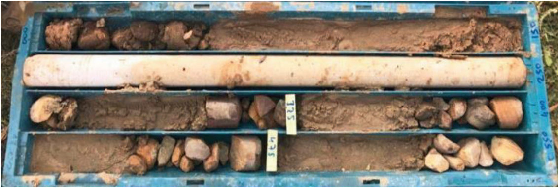
Figure A-2: Investigations géotechniques au PK 51+320 – Caisse 01 : 0 à 5.5m
