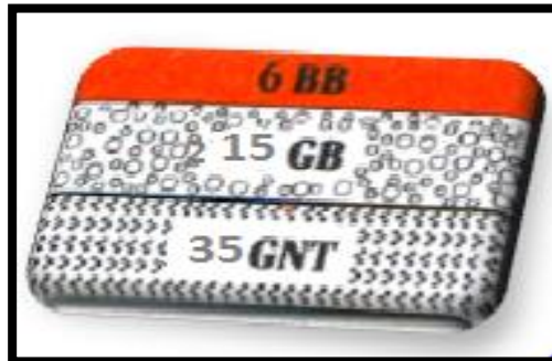
Figure 8.9 : structures de chaussées proposées
