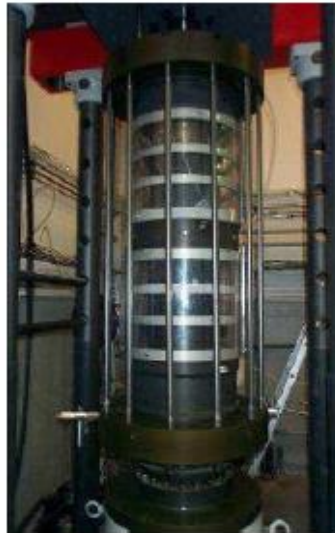
Figure I.3 : Essai triaxial appliqué sur le ballast
