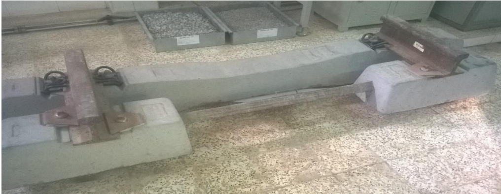
Figure IV.10: Traverses monobloc et bi-bloc en béton
