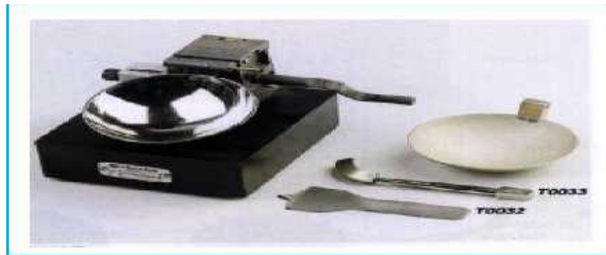
Schématisme de l'appareil de Casagrande
