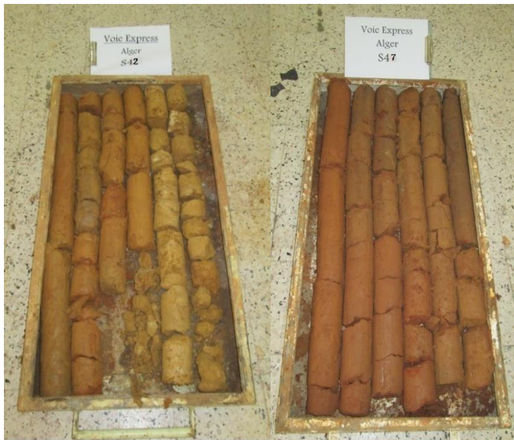
Figure V-3 : Echantillon d'un carottage.
