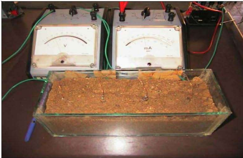
Figure 3-1 : Photos du dispositif initial (configuration Wenner sur modèle réduit).
