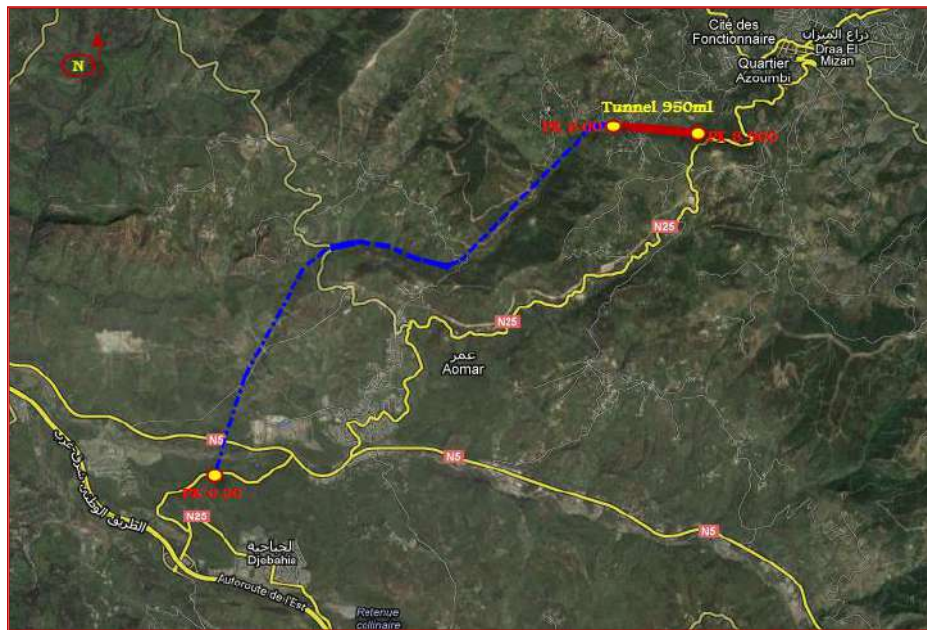
Figure II.2 localisation du tunnel par rapport au tracé
