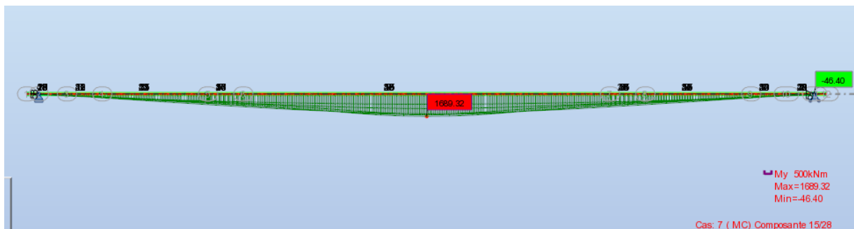
Figure D-15 moment fléchissant sous MC120 (travée 33m)
