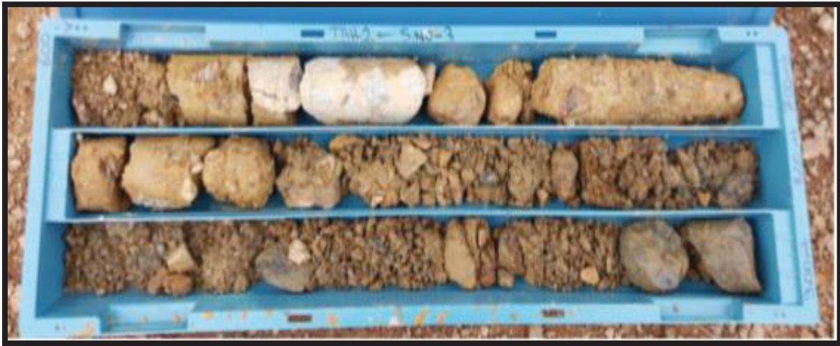
Figure IV.7. Vue des unités de flysch décomposé de degré avancé-moyen du sondage numéros TBH-2.
