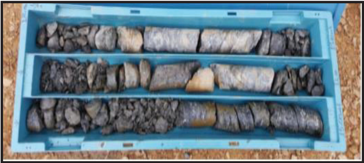
Figure IV.8. Vue des unités de flysch décomposé de degré faible-moyen du sondage numéros TBH-2.
