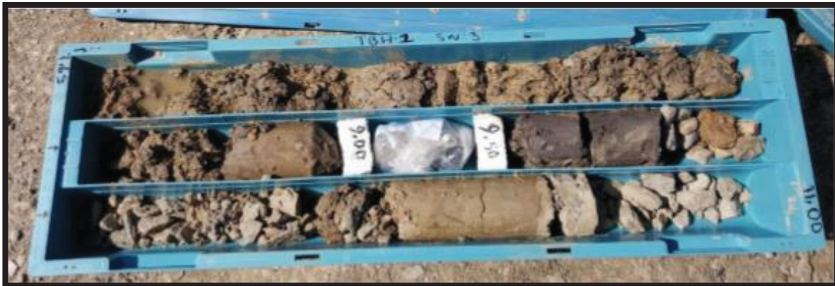
Figure IV.5. Vue des unités de glissement de terrain à matrice d'argile avec morceau de roche du sondage numéros TBH-1
