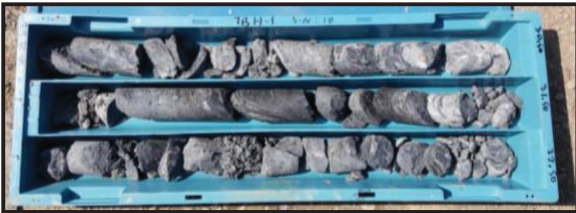
Figure IV.6. Vue des unités de flysch décomposé de degré faible-moyen du sondage numéros TBH-1.
