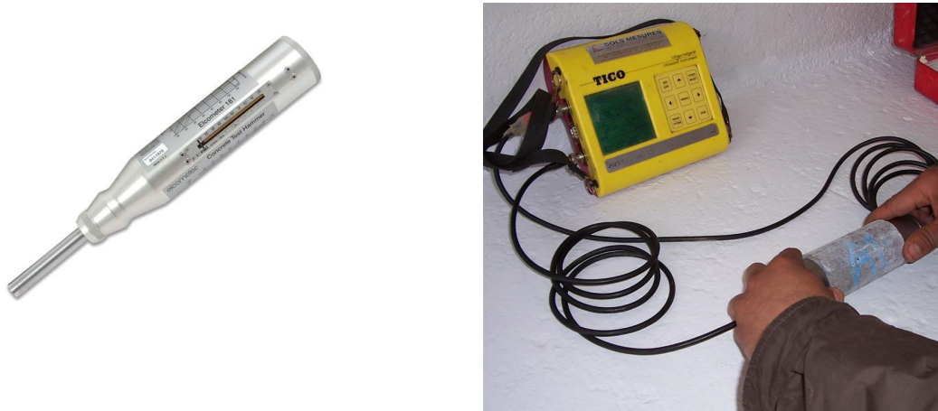
Figure 19: Scléromètre à béton et appareil ultrasonique
