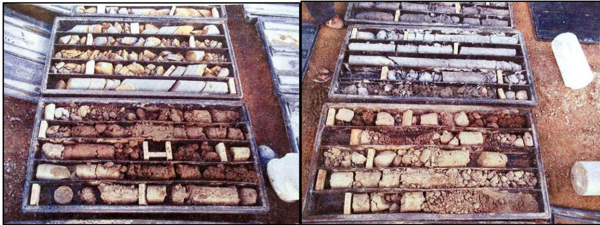
Figure III.2 : Sondage F2.3, profondeur 11-35m de la tête du forage. [7]
