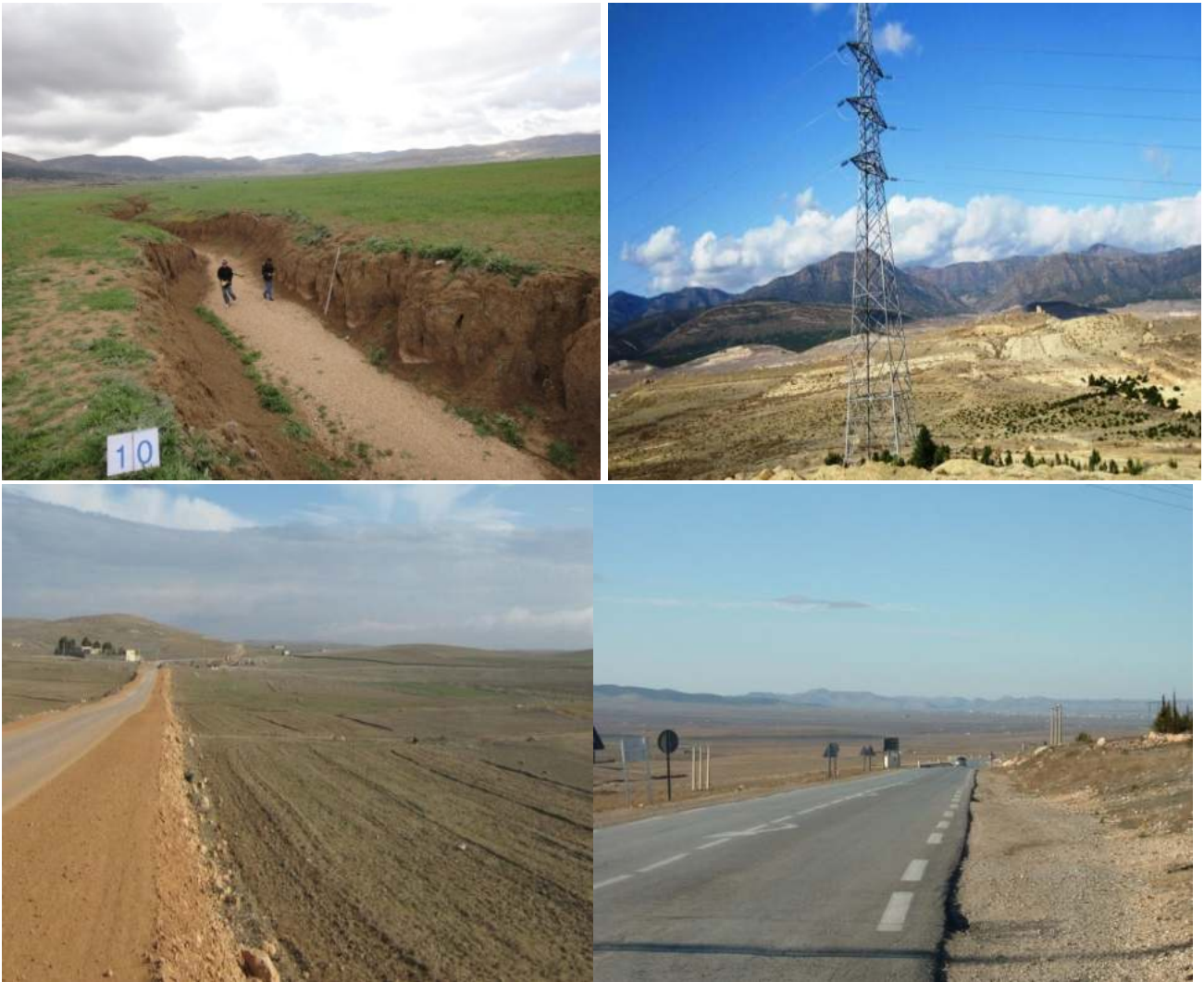
Fig.1 Les principales contraintes : routes (RN,CW),oueds, réseaux (électricité)
