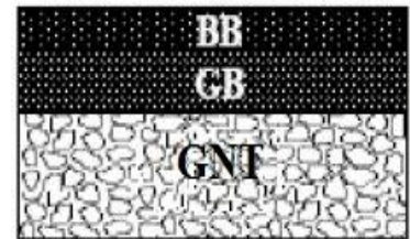
Figure 5-VI- La structure proposée (méthode de Catalogue).
