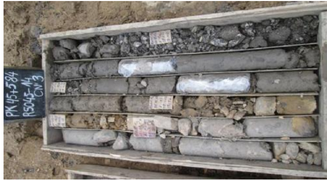
Figure A. 1 : Sondage carotté sur 25 m de profondeur.
