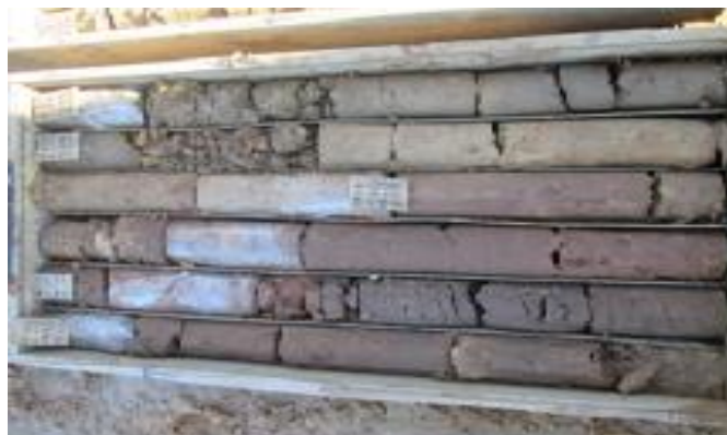
Figure A. 4 : Sondage carotté sur 20 m de profondeur.
