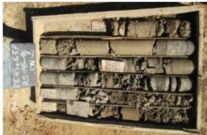
Figure A. 3 : Sondage carotté sur 25 m de profondeur.
