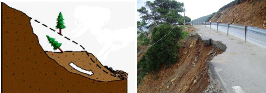
(a) : Mécanisme de glissement rotationnel simple
