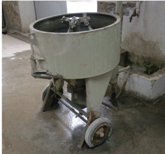
Figure 3.10 : Le malaxeur utilisé avec une capacité de 1/20 ème m 3 .
