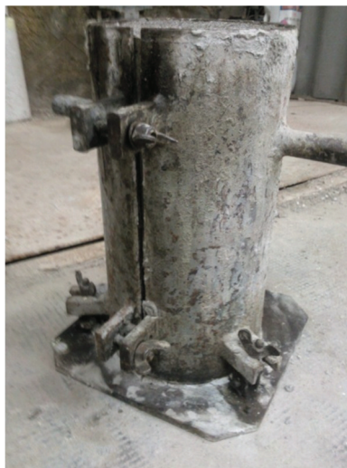
Figure 3.11 : L'éprouvette normalisée 16 x 32 cm 2 conformément à la norme NF P 18-406.
