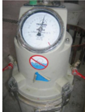
Figure 2.15 : Aéromètre pour la mesure de l'air occlus (45).
