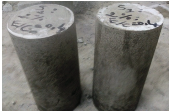
Figure 3.15 : Epreuve après le démoulage.
