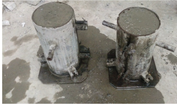
Figure 3.14 : Epreuve avant le démoulage.
