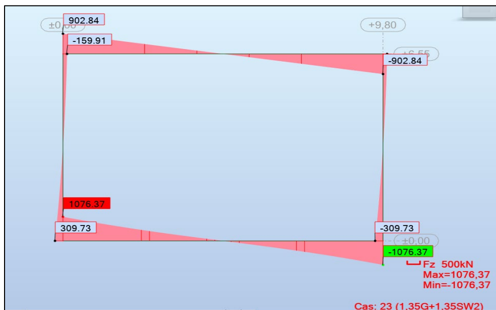
Figure 61: Diagramme de l'effort tranchant maximal à l'ELU
