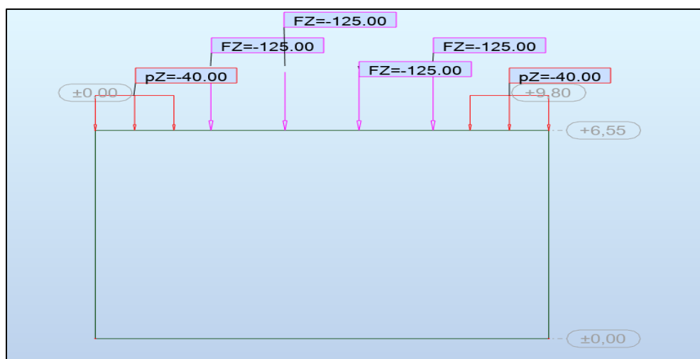
Figure 46: Modélisation du système de charge UIC 71
