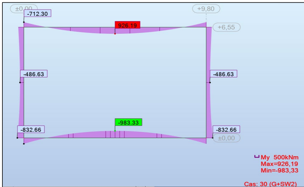
Figure 63: Diagramme de moment maximal a l'ELS
