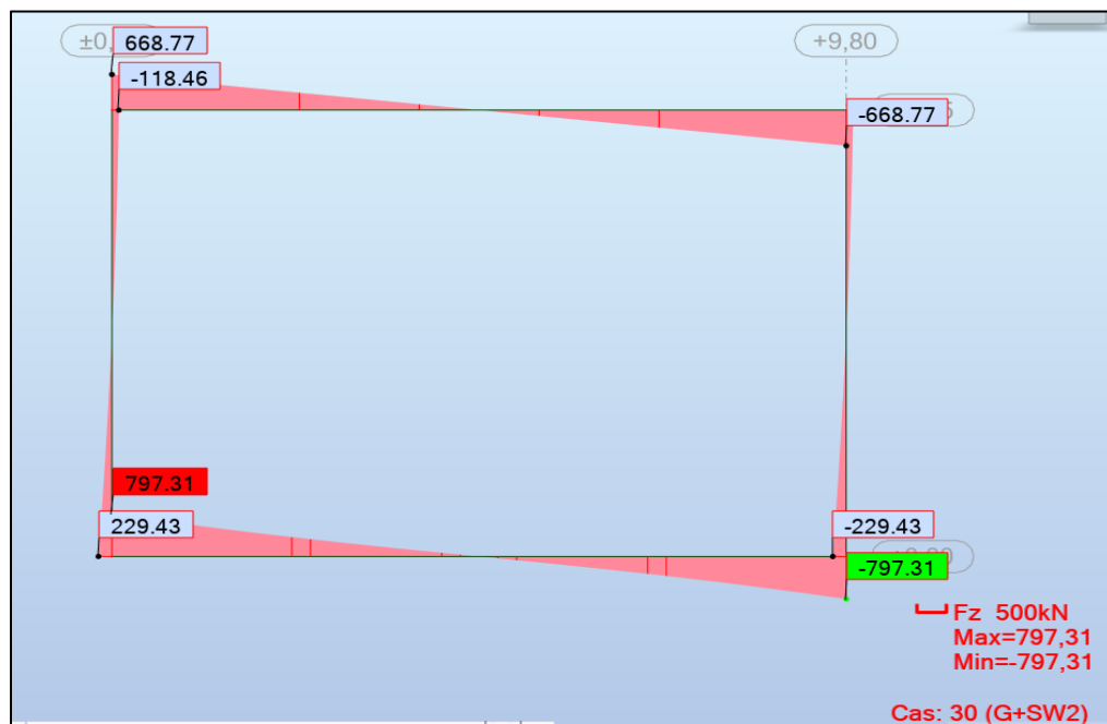
Figure 64: Diagramme de l'effort tranchant maximal à l'ELS
