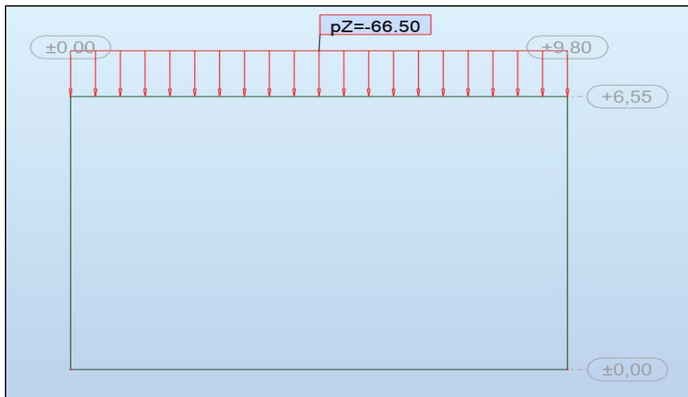
Figure 48: modélisation du système de charge SW/0
