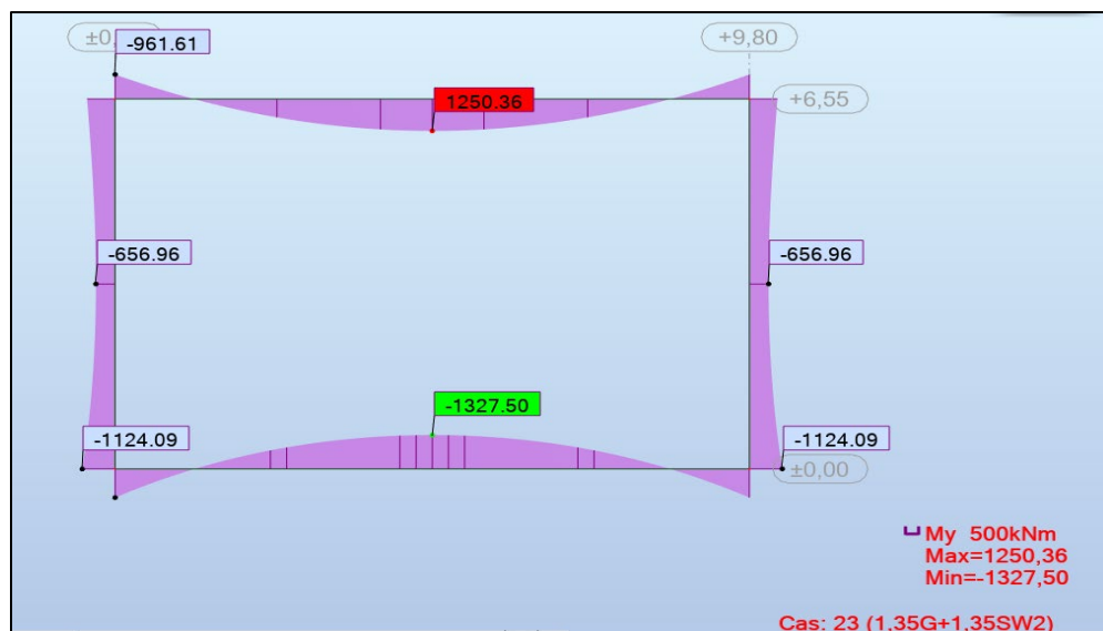
Figure 60: Diagramme de moment maximal à l'ELU
