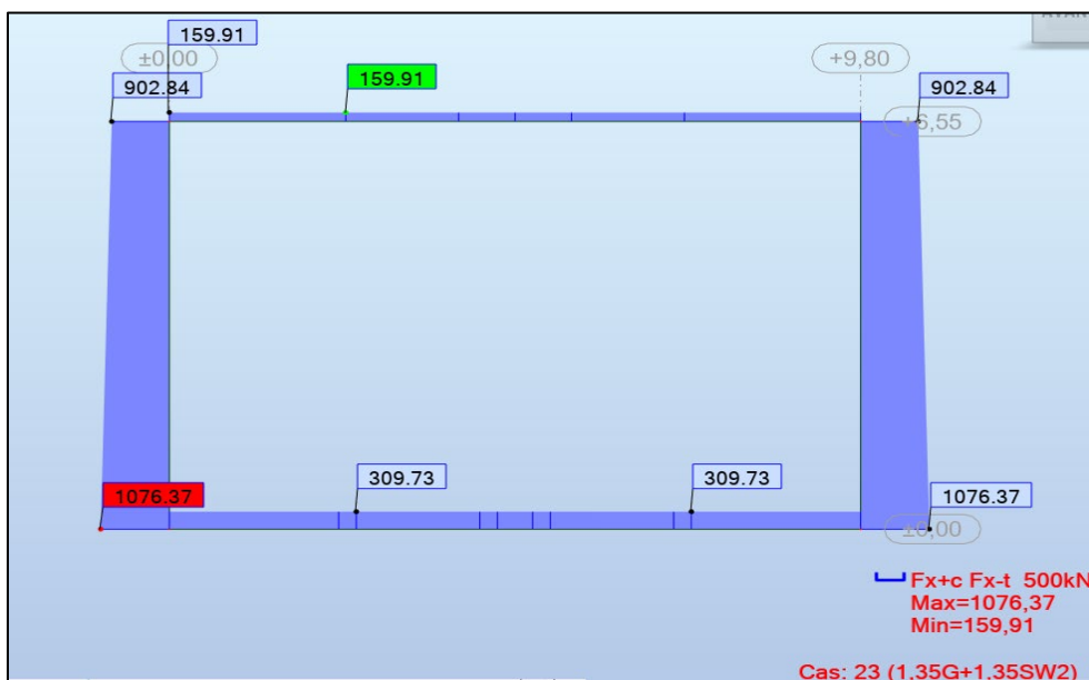
Figure 62: Diagramme de l'effort normal maximal à l'ELU
