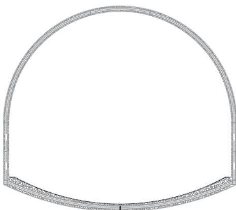
Figure IV.1 Forme du tunnel avec pied droit
