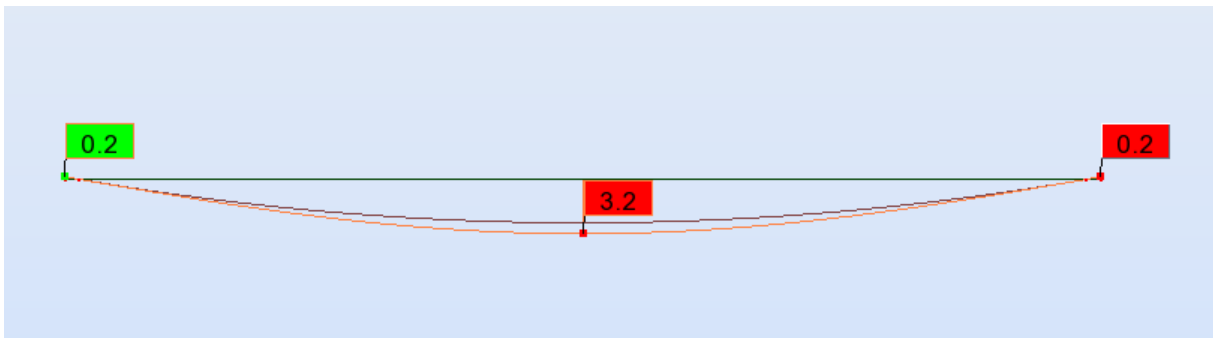
Figure VI.1 Flèche due au poids propre.
