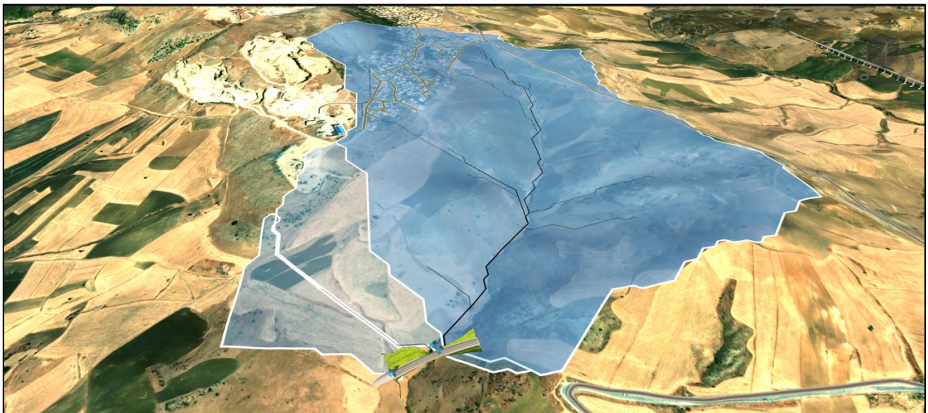
Figure V-8 : Délimitation BV N°16 par logiciel INFRAWORKS 2023
