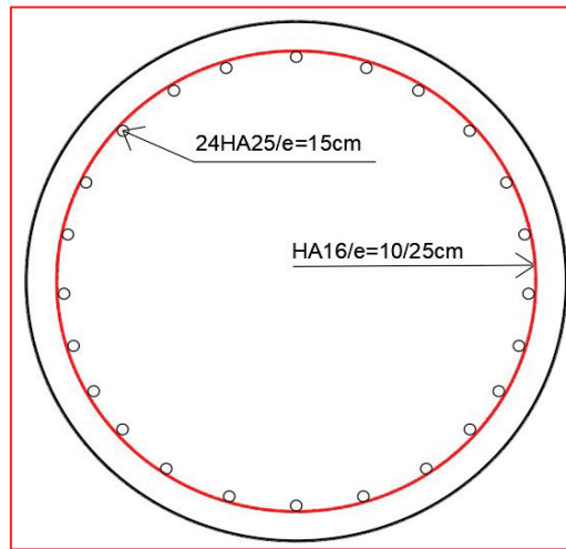
FIGURE N°XI. 10.FERRAILLAGE DU PIEUX.
