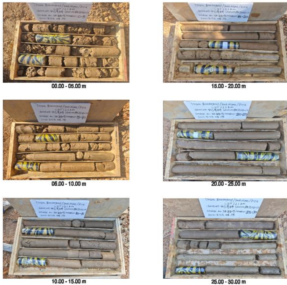
Figure B.20 : Présentation des carottes de forage obtenues entre 0,00 m et 30,00 m de profondeur.
