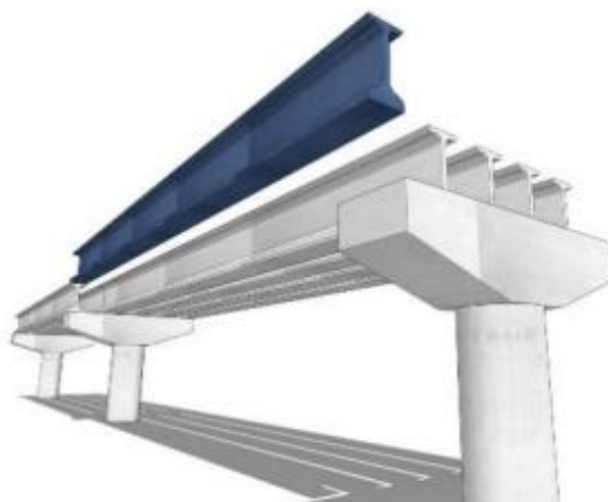
Figure II. 1:Schéma d'un pont à poutres
