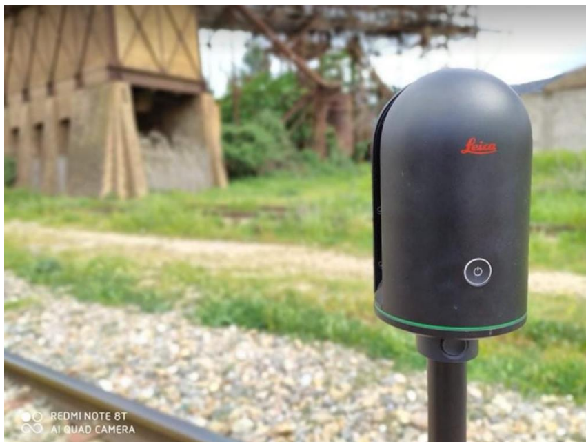
Figure XIV.1.Scanner 3D BLK 360 dans la gare El Maten
