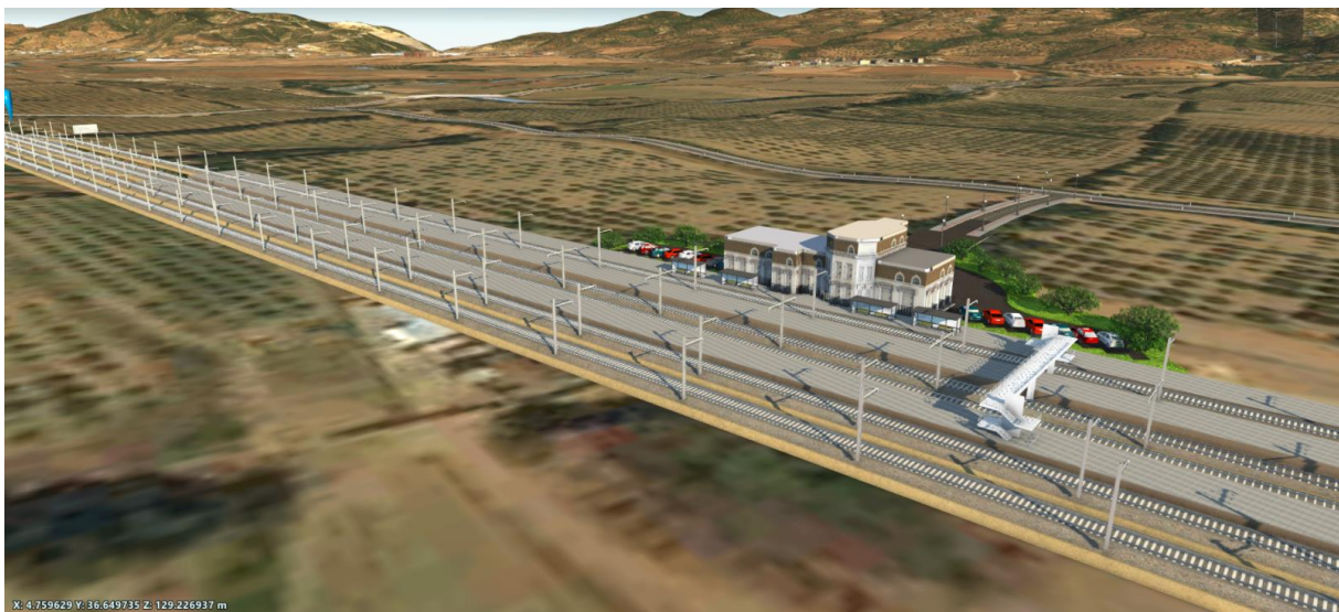
Figure XIV.13. Modélisation de la gare El Maten en respectant le plan (quais, bâtiment, parking, Passage supérieur et caténaire)
