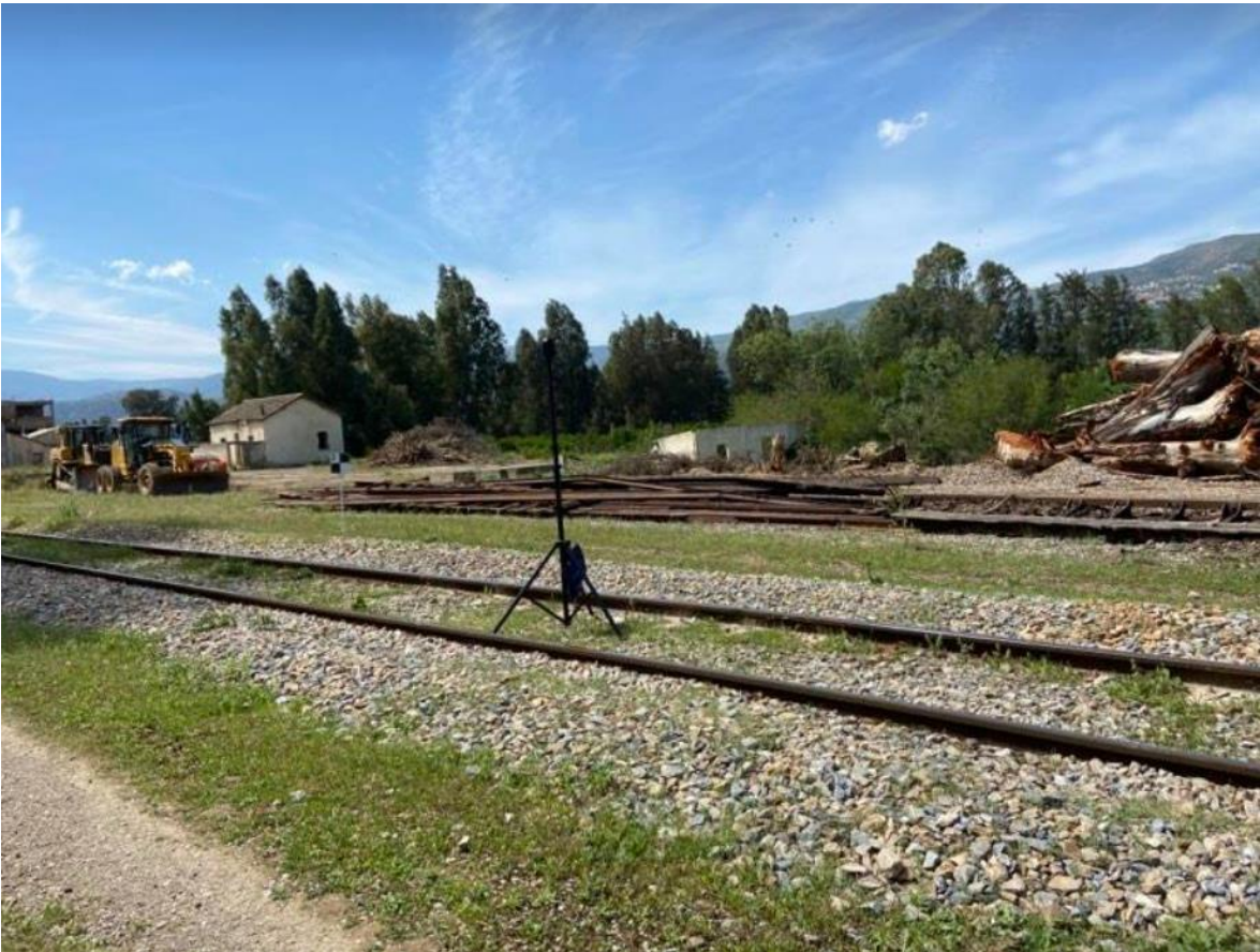
Figure XIV .3 et 4 Les scanner positionné entre différentes cibles marquées par des chiffres distinctes
