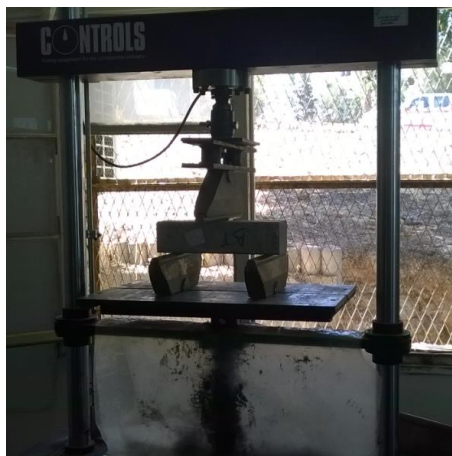
Figure 25: la machine de l'essai de flexion.
