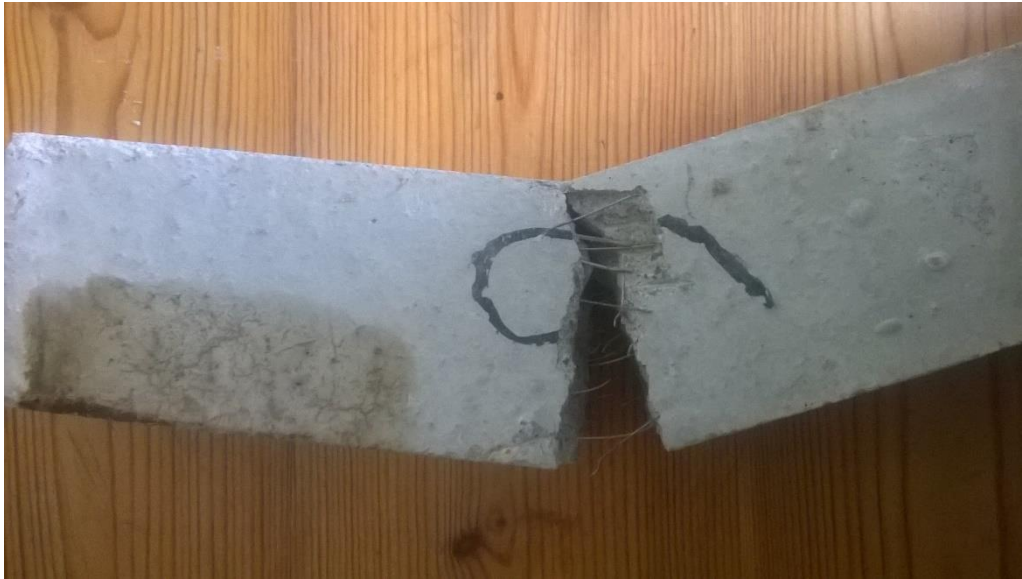
Figure 30: L'éprouvette du béton fibré type 02 après rupture (CNERIB-ALGER).
