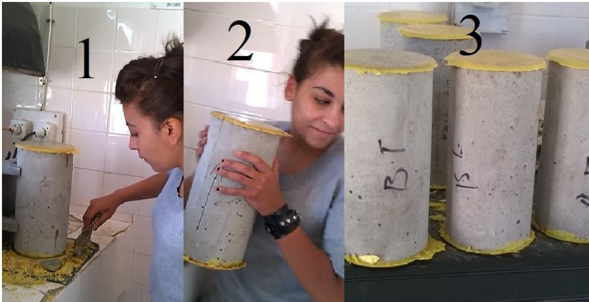
Figure 23: surfaçage des éprouvettes.
