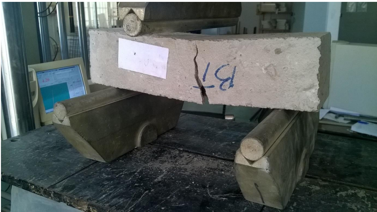
Figure 27: l'éprouvette du béton témoin après rupture (CNERIB-ALGER).
