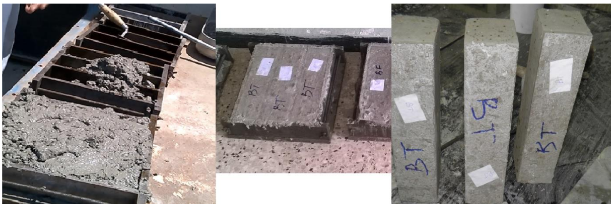
Figure 19: confection des éprouvettes 7 \times 7 \times 28 (cm).
