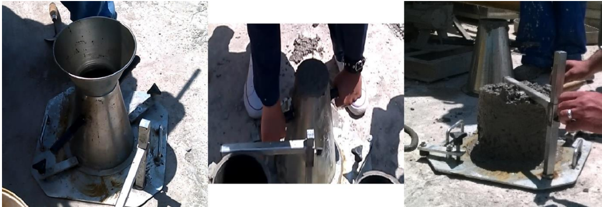
Figure 20: détermination de l'affaissement avec le cône d'Abrams.
