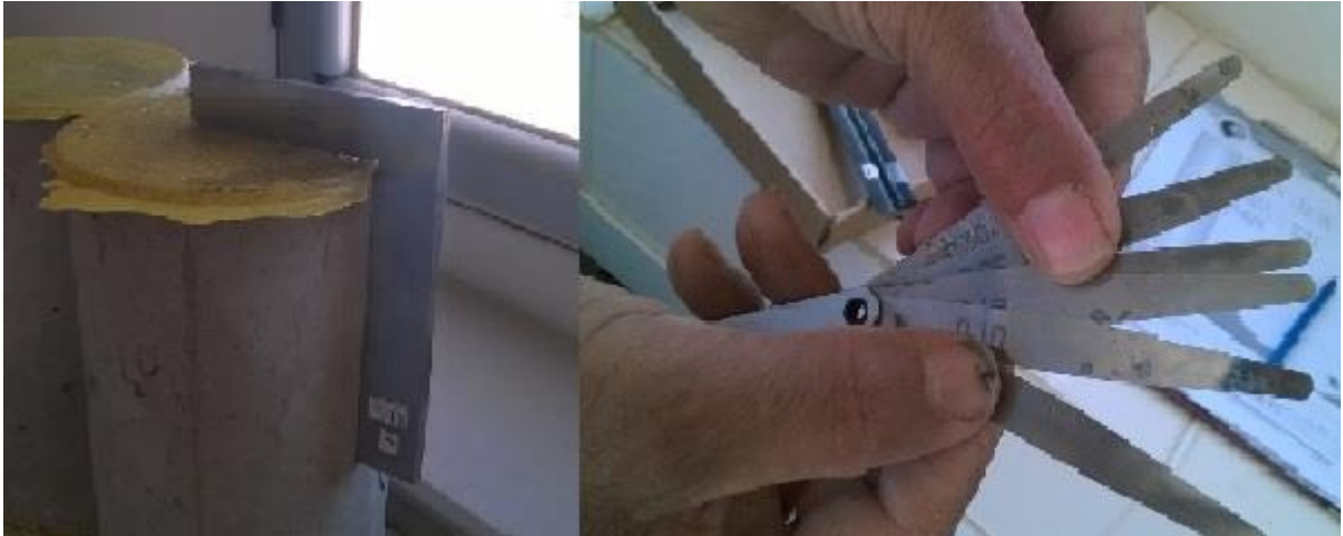
Figure 24: vérification de la conformité aux normes des éprouvettes.
