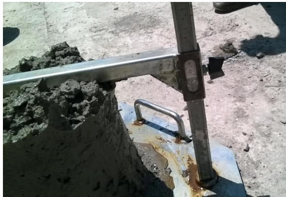
Figure 21: l'affaissement d'un béton témoin.
