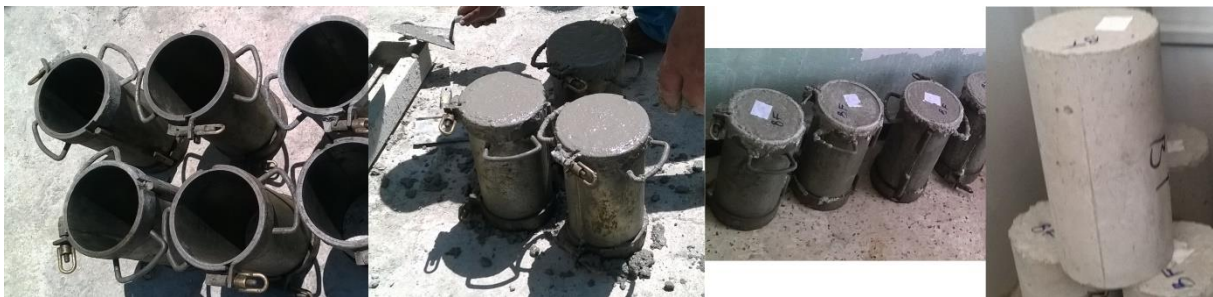
Figure 18: confection des éprouvettes 15 \times 30 (cm).
