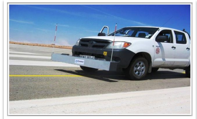
Figure III.1. Profilomètre placé à l'avant d'un véhicule
