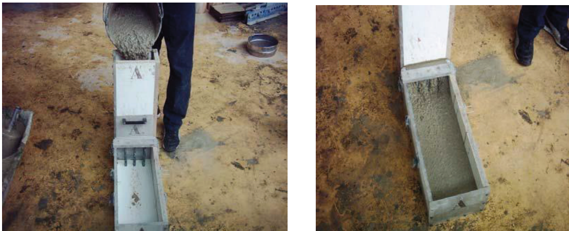
Figure III.11 : Remplissage du béton dans la partie verticale de L-BOX et Ecoulement du béton après l'ouverture de la trappe [41]
