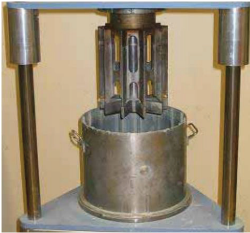
Figure III.1 : Rhéomètre BML à cylindres coaxiaux [39]
