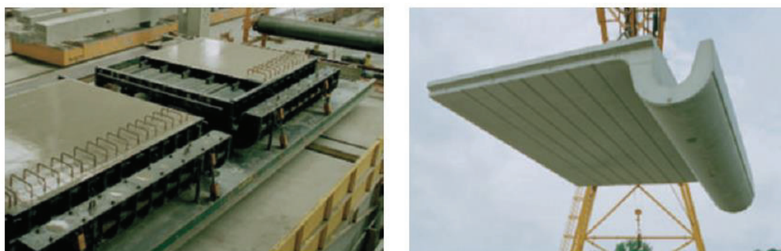
Figure V.6 : Application du BAP a la préfabrication (b) (rapporté par [46])
