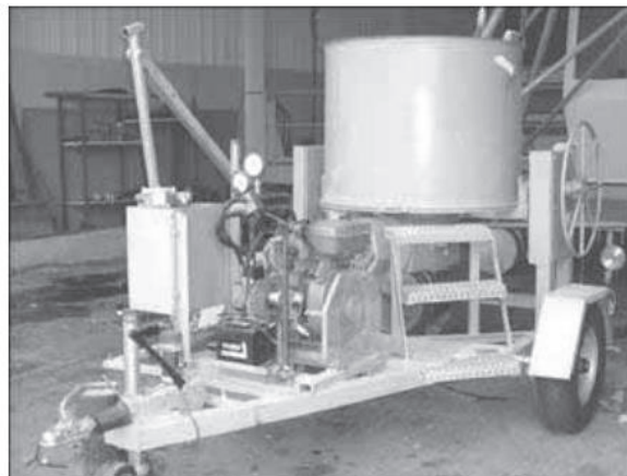
Figure III.3 : Rhéomètre à cylindres coaxiaux Cemagref-IMG (volume de l'échantillon de 500 L ; ce rhéomètre était initialement dédié à l'étude des laves torrentielles) [39]
