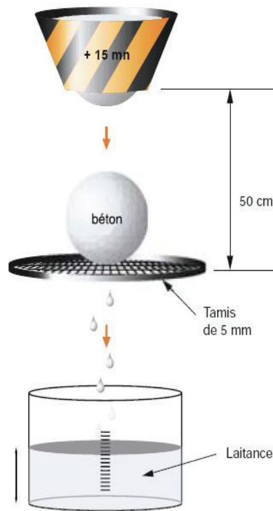
Figure III.16 : Essai de stabilité au tamis
