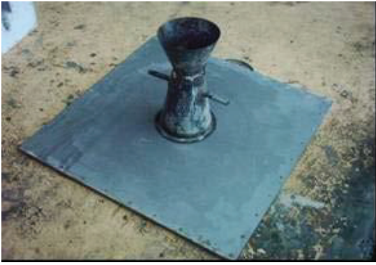
Figure III.8 : Essai d'étalement au cône d'Abrams [41]
