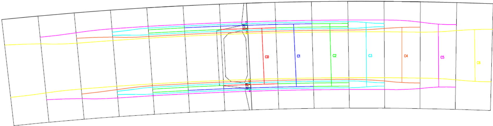
Figure VI.6 : Tracé en plan de câbles de fléau
