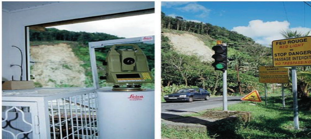
Figure IX.13 surveillance du glissement de terrain de la Médaille à Fort de Grance (Martinique) au moyen d'un tachéomètre (photo de gauche). La détection d'une instabilité entraîne l'activation d'un feu rouge qui stoppe la circulation sur cette portion de la route (photo droite) [16]
