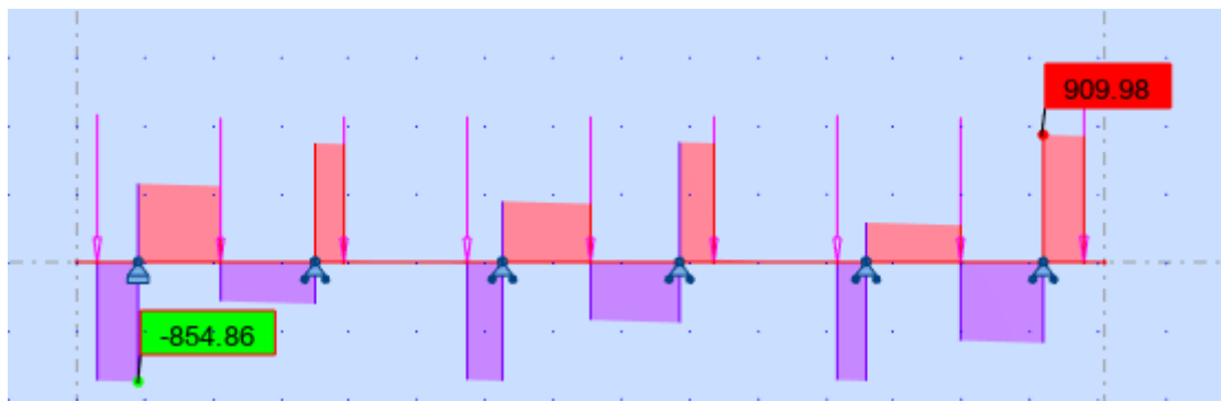
Figure VIII. 7. Diagramme de l'effort tranchant sous G à l'ELU.
