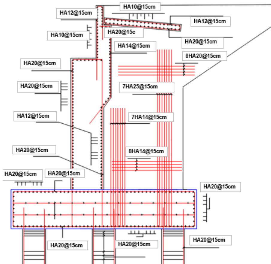
Figure XI.11 : Ferrailage de la culée
