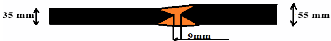
fig.VI-29 Un chanfreiné en X des semelles inférieures.
