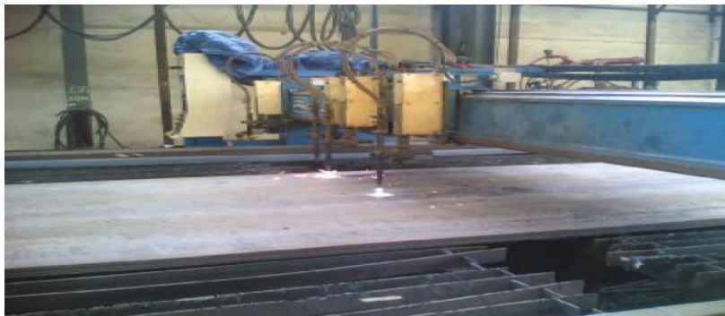
fig.VI-43 Découpage des tôles à chaud avec chalumeau Oxycoupeur (usine Rouïba .sapta)
