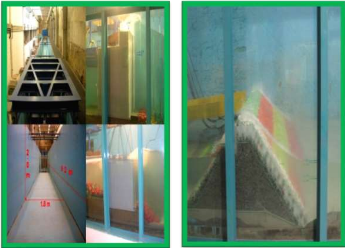
Figure IV.2 : Canal à houle
